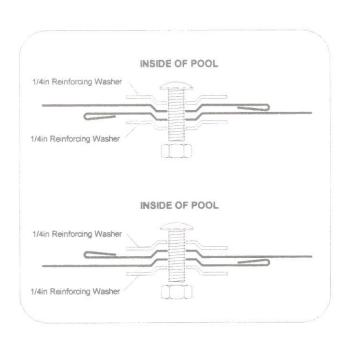
INSERT THE SCREWS FROM INSIDE OF WALL.
